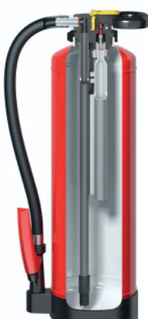
*Beim Aufladefeuerlöscher handelt es sich um ein Gerät, bei dem das Löschmittel und das Treibgas getrennt gehalten werden (siehe Schnittzeichnung Typ STAR mit innenliegender Treibmittelflasche). Erst kurz vor Inbetriebnahme wird die Treibmittelflasche über die Auslösearmatur geöffnet.*
